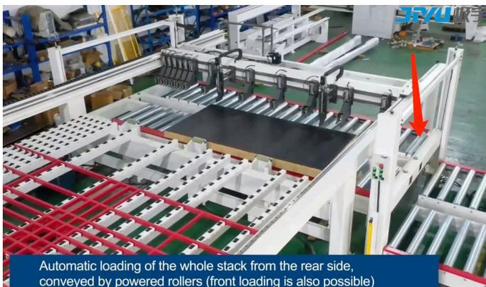
Управление роликами подъемной платформы.
