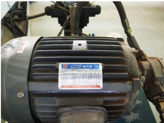
Мощность эл. мотора гидравлического подъемника 3кВт.
